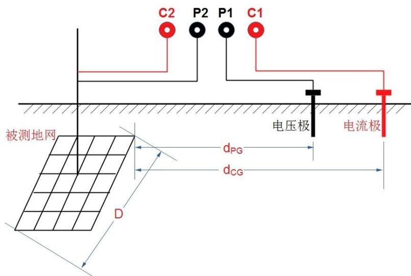
夹角法：图 5-2 中  $d_{CG}$  为 3~5D，对超大型接地装置则尽量远； $d_{PG}$  的长度与  $d_{CG}$  相近。如果土壤电阻率均匀，可采用  $d_{CG}$  和  $d_{PG}$  相等的等腰三角形布线，此时两根引线夹角  $\theta$  约为  $30^\circ$ ， $d_{CG} = d_{PG} = 2D$ 。只要条件允许，推荐采用电流—电位线夹角布置的方式。
