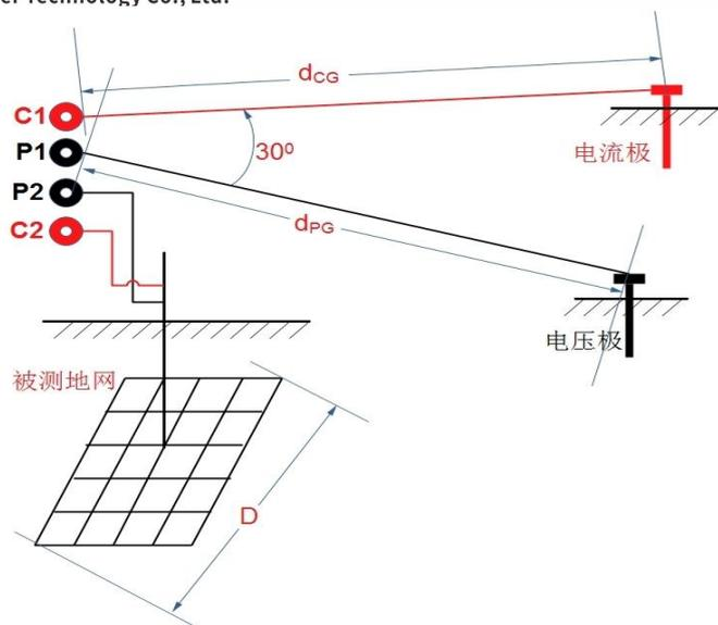
图 5-2 夹角法测量接线示意图
